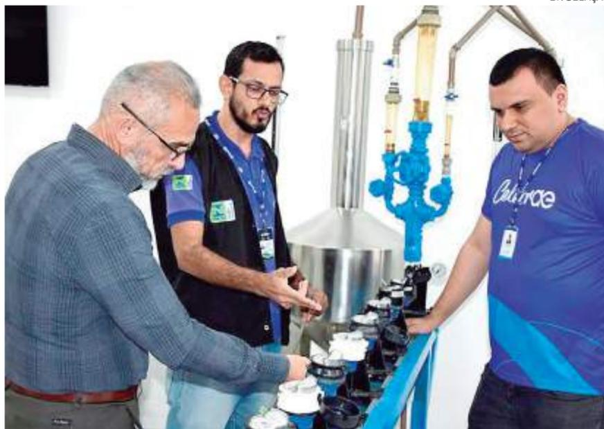
Média de 200 hidrômetros, por mês, é submetida a testes de análises no laboratório de hidrometria
