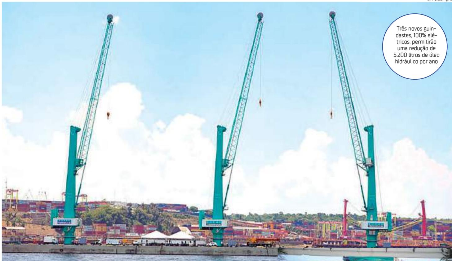
Três novos guindastes, 100% elétricos, permitirão uma redução de 5.200 litros de óleo hidráulico por ano
