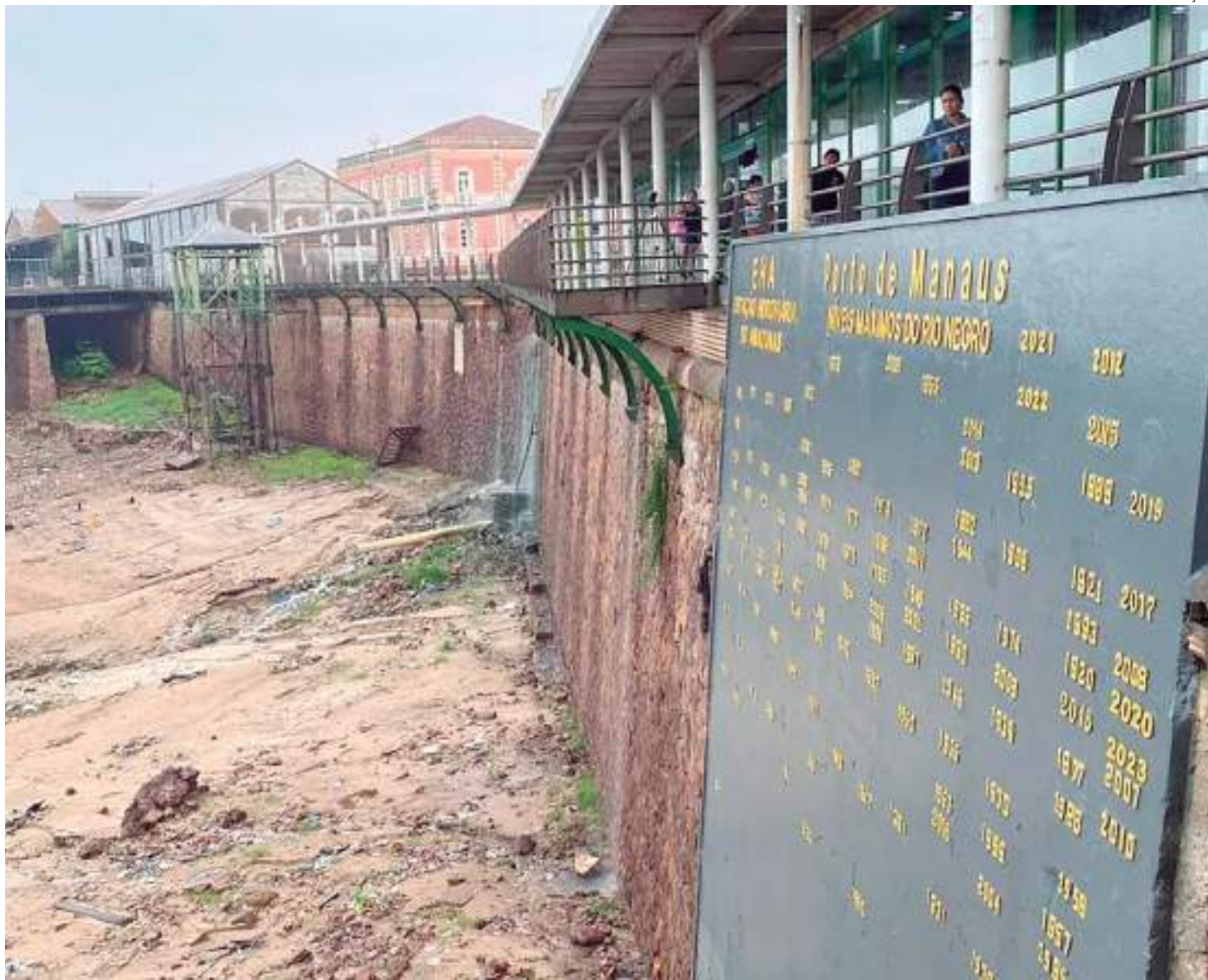
Rêgua de medição do nível do Rio Negro localizada no Porto de Manaus
