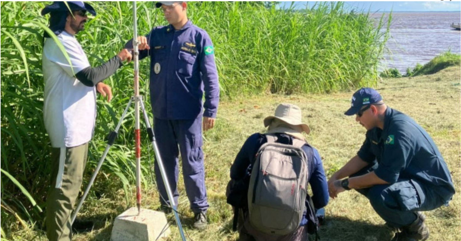
Levantamento determina coordenadas geográficas e altitudes ortométricas
